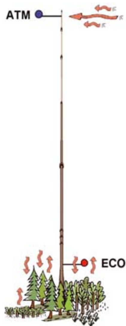
▲ En schematisk illustration av hur en kombinerad ICOS-mätplats kan se ut: I toppen av den höga masten (på 100–150 meters höjd) är gasintag och mätutrustning för atmosfärsmätningar placerade (ATM), medan majoriteten av instrumenten för mätningar av det lokala ekosystemet är monterade strax ovanför trädtopparna (ECO). Dessutom utförs mätningar av nederbörd, marktemperatur, biomassa tillväxt etc. i nära anslutning till masten.
